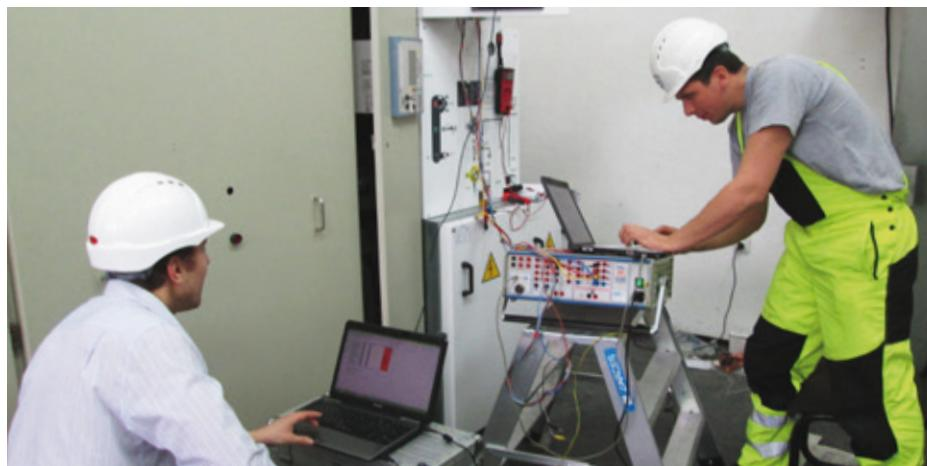
**Parametrisiranje i ispitivanje 35 kV postrojenja sopstvene potrošnje HE Bočac**
