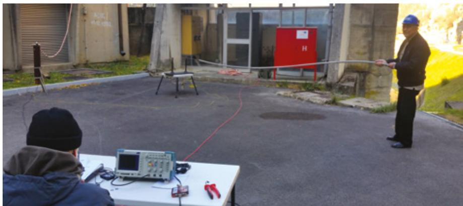
Simuliranje zemljospoja na 35 kV mreži putem električnog luka / Earthing simulation at 35 kV network through electric arc
